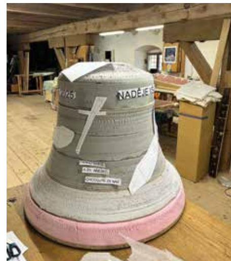
Model, podle kterého se bude zvon odlévat Foto: Ladislav Rozsypal
