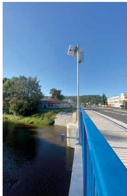
Hladinoměr je umístěn na ulici Cáhlovské na konstrukci mostu přes Svratku
