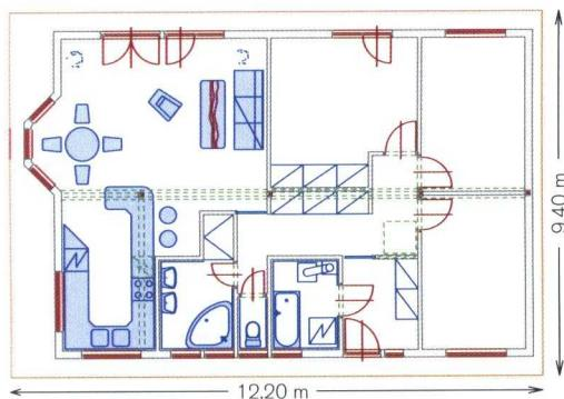
Dřevodům Navrátilových charakterizuje preciznost a současně jednoduchost provedení, čistota tvarů a maximální účelnost. **Zvláštností domu je arkýř ve štítové stěně**. Vytváří sice dominantní pohledový prvek, ale jinak dům působí skromně a nesnaží se předstírat něco, čím není. Svými půdorysnými rozměry rozhodně patří k těm menším, nabízí však dvakrát větší obytnou plochu, než měla tato rodina k dispozici ve vzpomínaném bytě. A navíc každé z dětí konečně získalo svůj vlastní pokoj.
