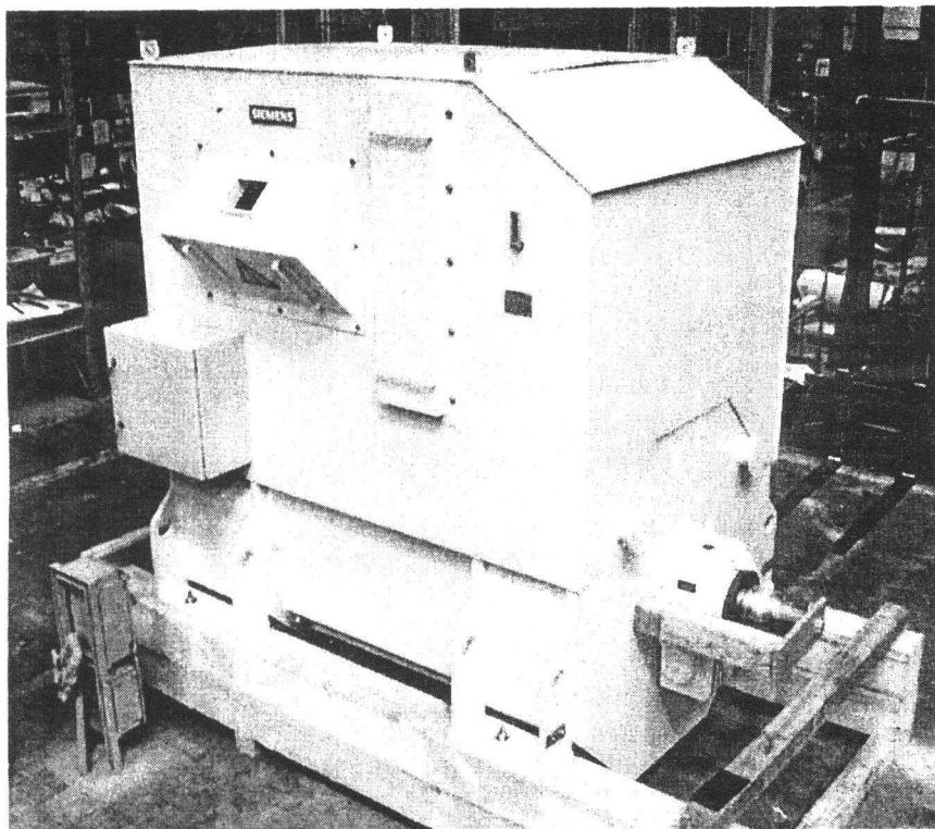
Vysokonapěťový synchronní generátor 1FJ3 712-85B90, 6000 V, 2 243 kVA, 60 Hz,
